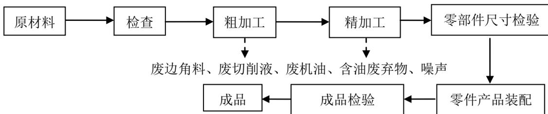
图 2 项目工艺流程及产污环节图
