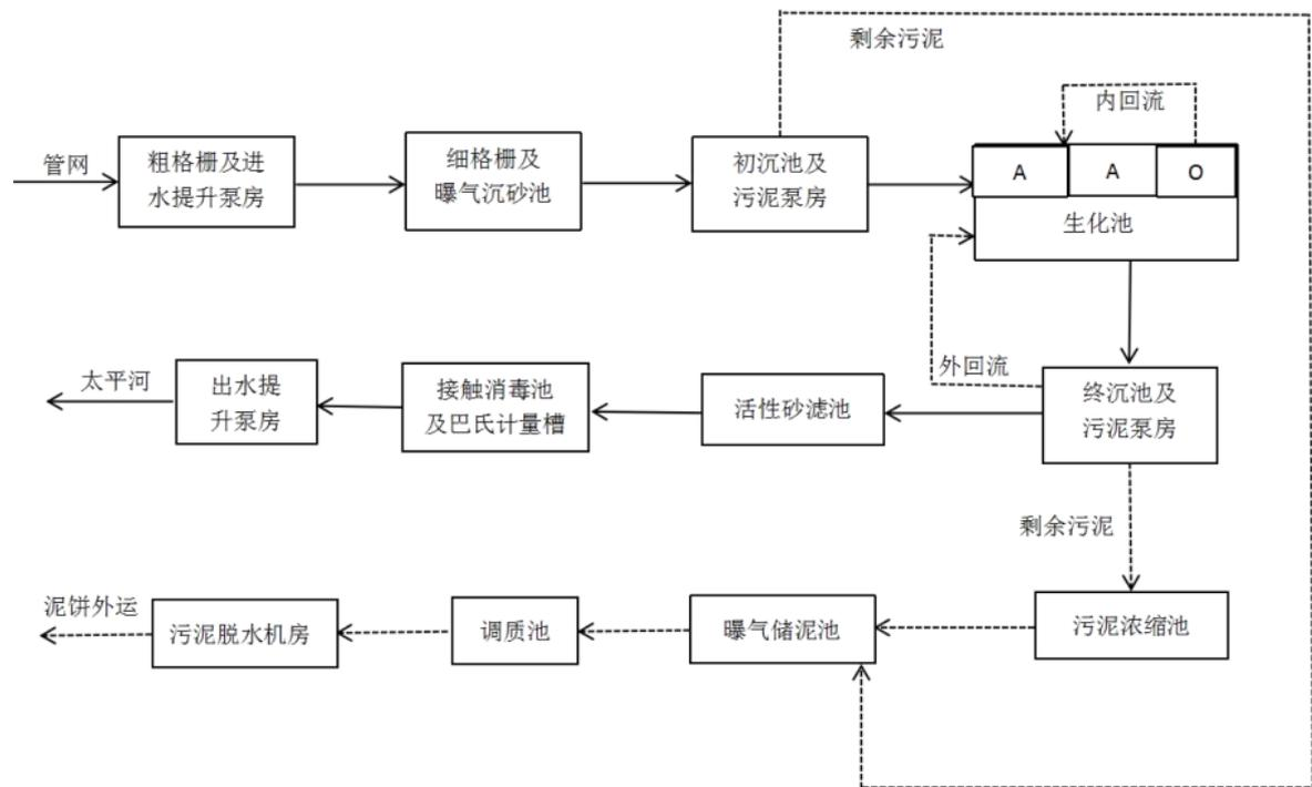
图 4 西咸新区第一污水处理厂工艺流程图
