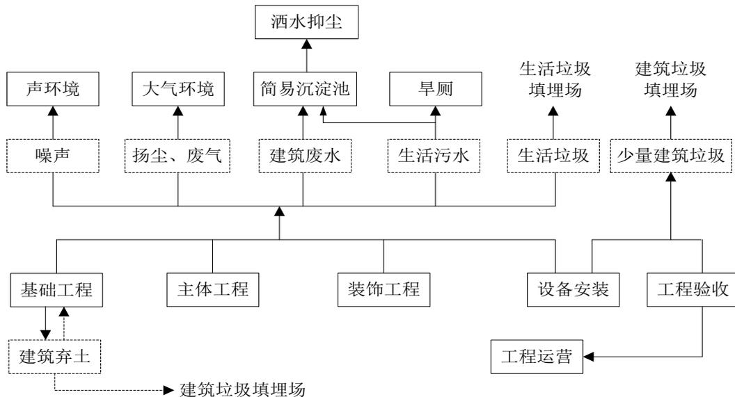
图 3.2-1 本项目施工期产污环节图
