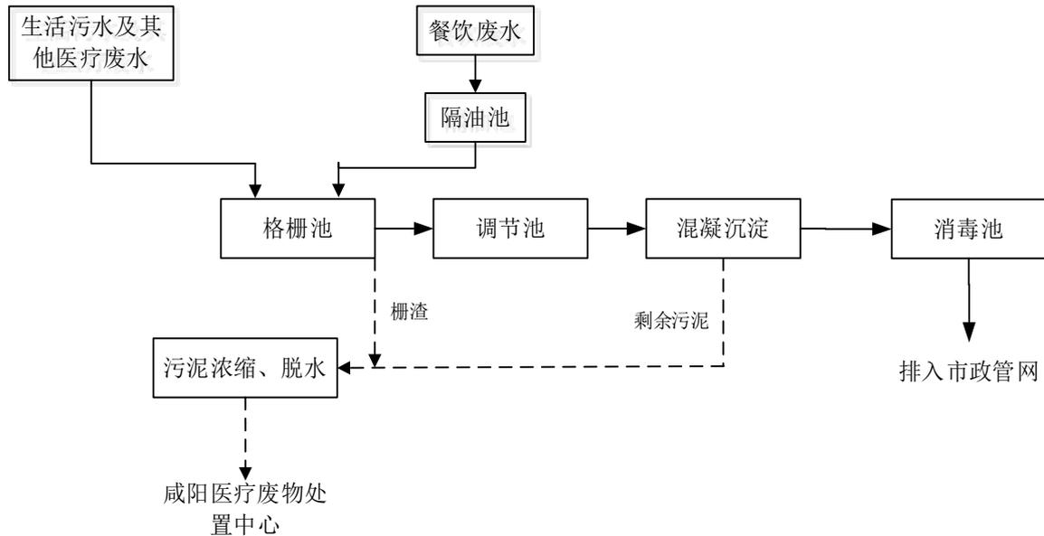
图 6.2-1 本项目污水处理站工艺流程图
