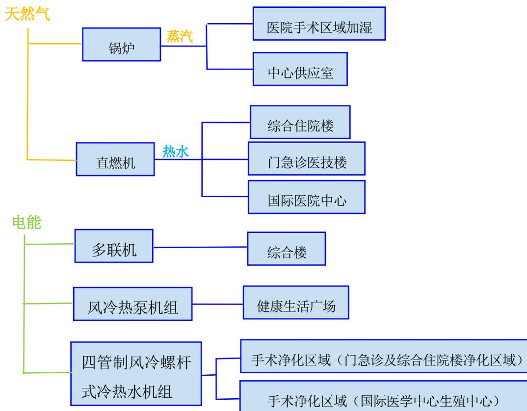
图3.1-3 项目能源及冷热源流程图 (t/d)
