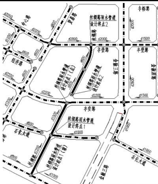
图9 丝绸路雨水管道图
